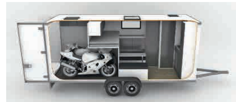
Cube 5. Maße innen in mm: L 5.000 (bis 5.500 möglich) x B 1.850 x H 2.050. Leergewicht: 1.400 kg, Zuladung 800 kg (bis 1.300 kg möglich). Basispreis 28.999 Euro inkl. MwSt.
